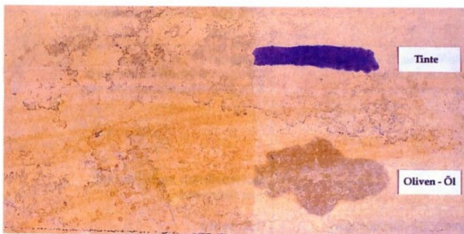
Abb. 1: Versuch mit Solnhofer Platten, links mit und rechts ohne Fleckschutz.
