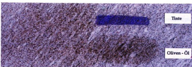
Abb. 3 und 4: Fleckschutz auf zwei Granitsorten, links mit und rechts ohne Fleckschutz.
