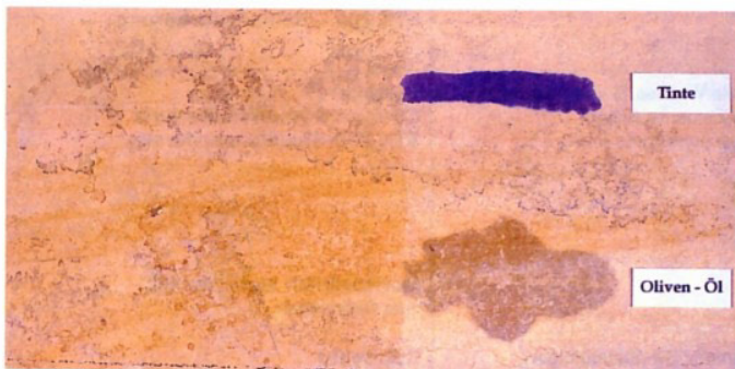
Abb. 1: Versuch mit Solnhofen Platten, links mit und rechts ohne Fleckschutz.
